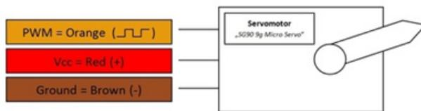
Pinbelegung des Servomotors
